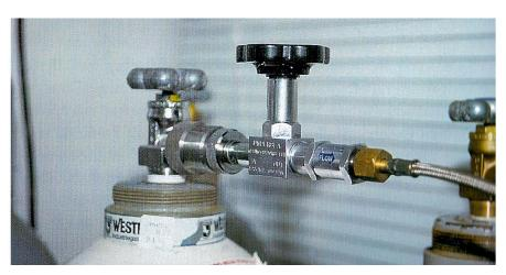
Nur mit Nadelventilen und einer Messsode mit Digitalanzeige lassen sich genaue Nitrox-Gemische herstellen.
